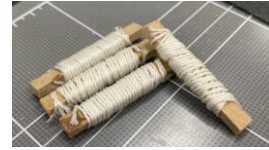
▲ 실물 모델 제작 (잉여 Strip에 면줄을 감은 면진 장치)
